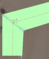
Angle de cadres pour charges des plus élevées. Grâce à sa stabilité de forme et d'angle, l'assemblage GSA®-LMV est d'une grande simplicité. Cette solution enfichable convainc du design jusqu'au montage.
