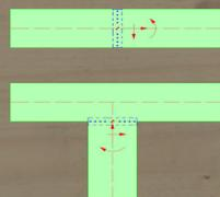
Le dimensioni di trasporto limitate richiedono giunti di montaggio adeguati in cantiere. I carichi delle colonne devono essere guidati attraverso travi senza assestamento o le architravi devono essere collegate rigidamente alle colonne. La GSA-L innestabile consente il montaggio senza fatica di connessioni ad alta carica.
