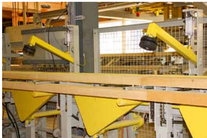
Die fertig keilgezinkten und verpressten Lamellen werden mittels Paternoster Stück für Stück gestapelt
