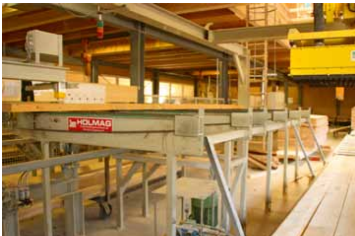
Lagenweise Entstapelung und Aufgabe der Rohware mit anschließender Vereinzlung und Zuführung zur Keilzinkenanlage
