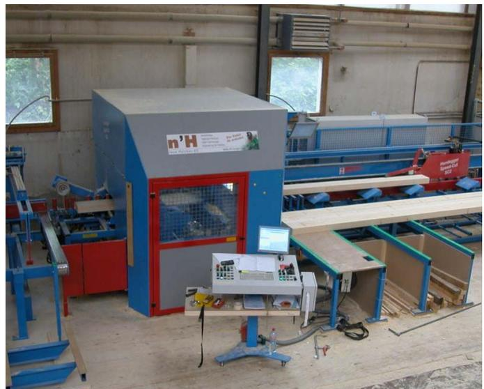
Bild: Stabbearbeitungsanlage Typ Speedcut 3
