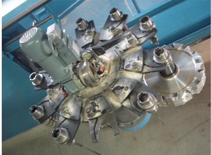
Bild: Vollautomatischer Werkzeugwechsler
