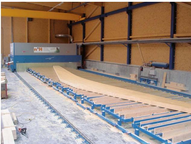
Bild: Portalbearbeitungsanlagen Typ PBA
