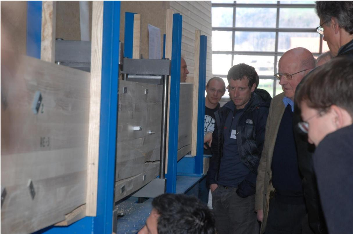
Prüfung eines BSH-Träger GL60 in Eschenholz
