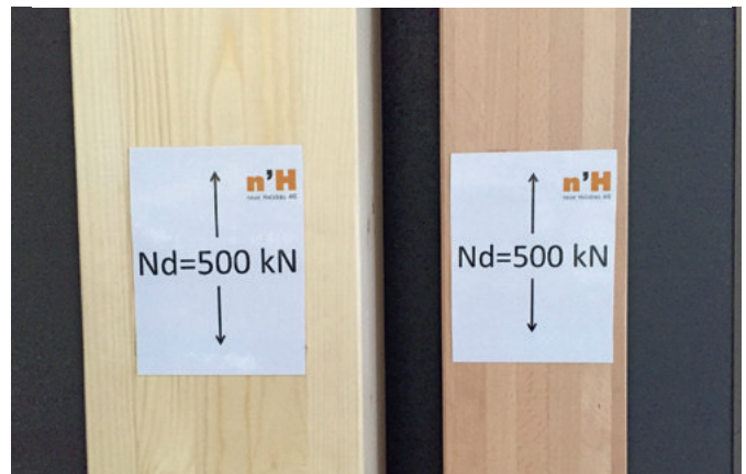
Bei gleicher Zugkraft benötigt man für Fichten-BSH einen größeren Querschnitt im Vergleich zu Buchen-BSH
