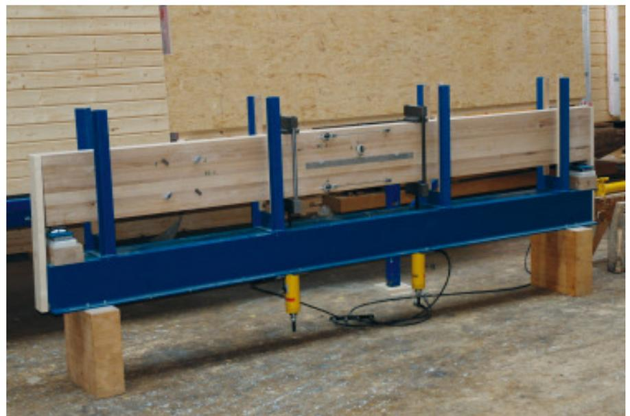
Prüfung eines Probekörpers GL 60.
