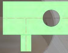
Das GSA®-ALP-VERFAHREN (alternative load path) ist generell anwendbar für Durchbrüche sowie Schubverstärkungen bei Trägern. Durchbrüche bis 50 % der Trägerhöhe können ohne Schwächung des Schubwiderstandes ermöglicht werden.
